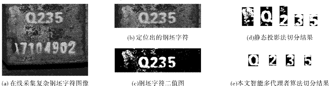
图 5 复杂钢坯字符切分(钢坯端面腐蚀、字符粘连)
