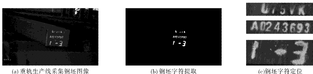
图 4 钢坯号字符图像定位
