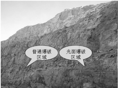
图 8 蒙库铁矿 1 080 m 水平光面爆破效果对比图 Fig. 8 Mengku iron smooth blasting effect of 1 080 m level comparison chart
