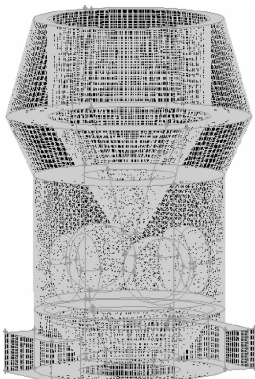
图 3 模型计算网格
