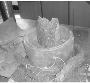
图 4 低碳超高强石渣混凝土的破坏形态
