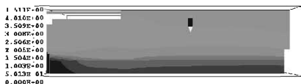
图7 机械排烟下疏散通道中线立面烟气分布图
