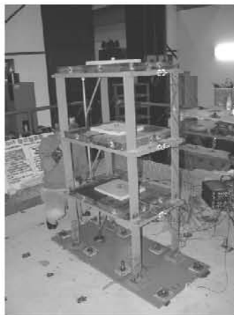
图 2 钢框架的实验室模型
