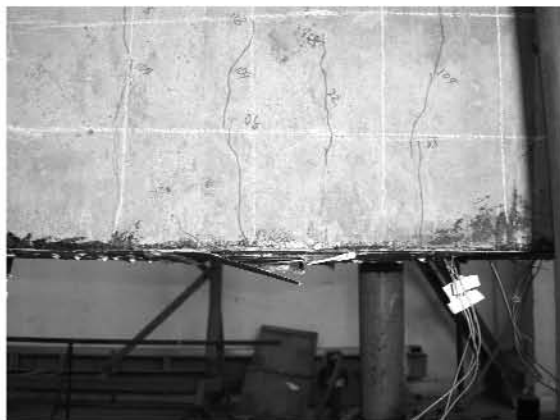
图 2 L2 的破坏实况
