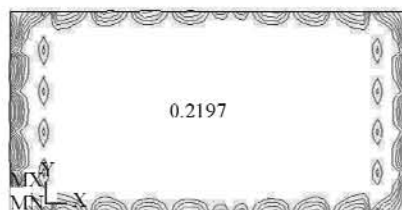
图3 一层楼板应力 \sigma_1 (MPa)
